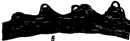
Рис. 11. Выдавливание проволок прядей: а - в одной пряди; б - в нескольких прядях
